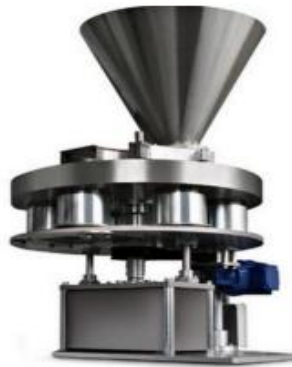
Figura 25. Dosificador de seis vasos telescópicos accionado por un servomotor [42].
