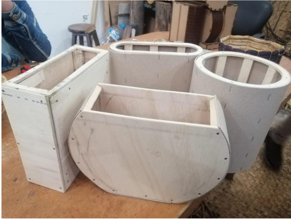
Imagen 41 Moldes de madera para realizar los tejidos. Fuente: Elaboración propia.
