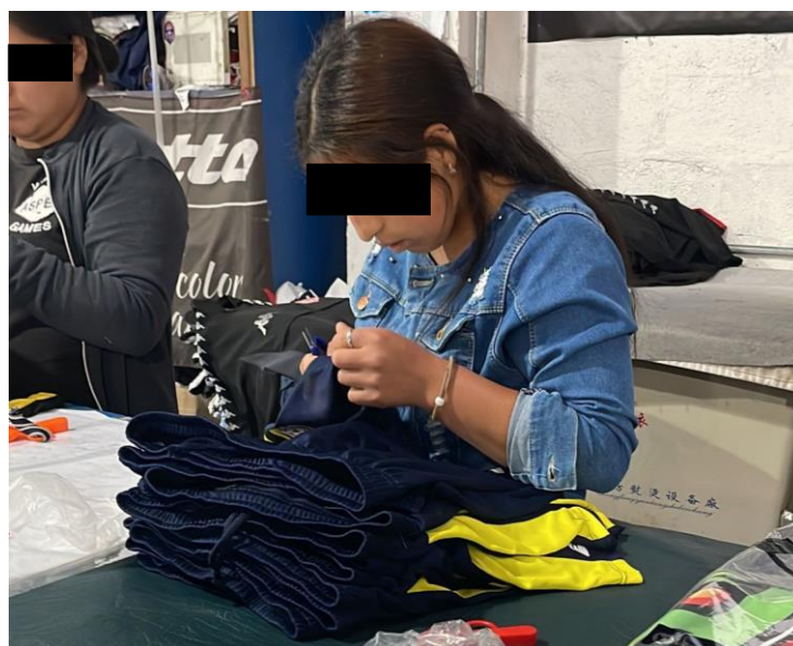
Figura 18. Operario realizando el proceso de control de costuras
