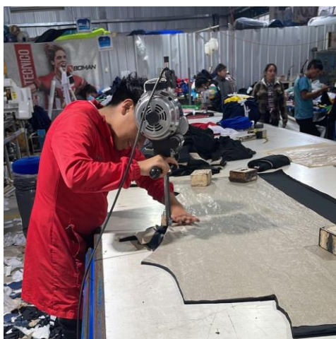
Figura 13. Operario realizando el proceso de corte
