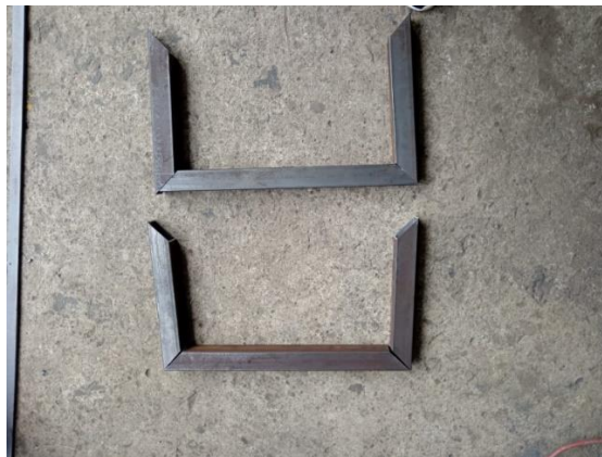
Figura 29. Tubos cortados para el soporte
