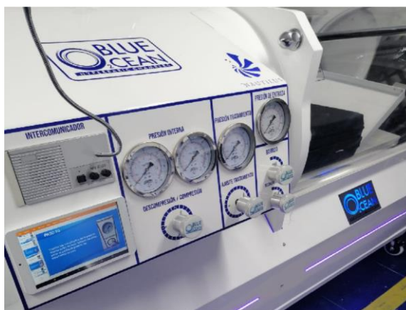
Figura 8. Panel de control de cámara hiperbárica [23].
