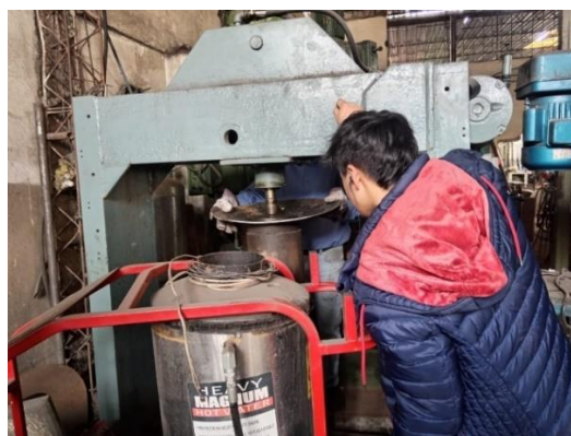
Figura 34. Prensado del cabezal y la compuerta
