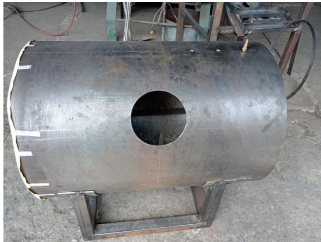
Figura 41. Agujeros para los accesorios y la ventana
