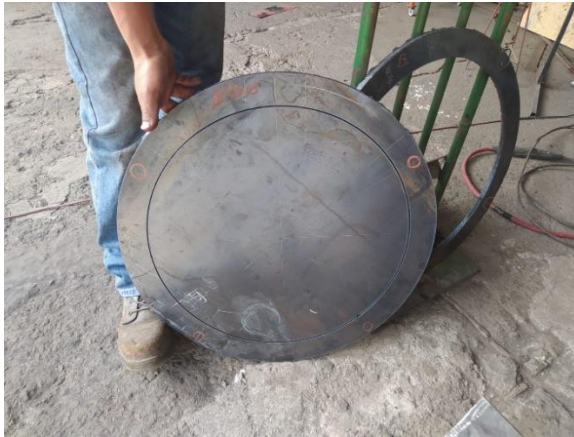
Figura 28. Anillos de la compuerta y el mando cilíndrico
