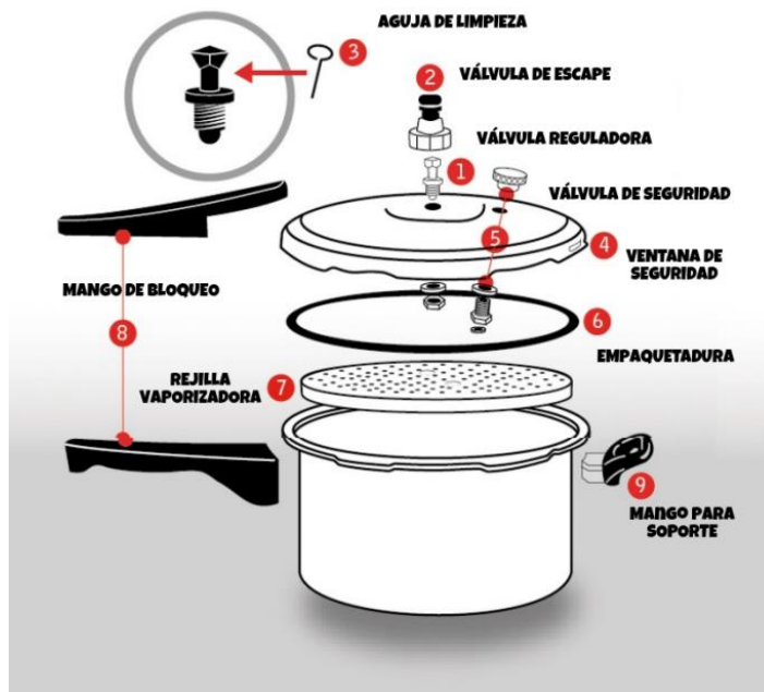
Figura 13. Despiece de una olla de presión [45].
