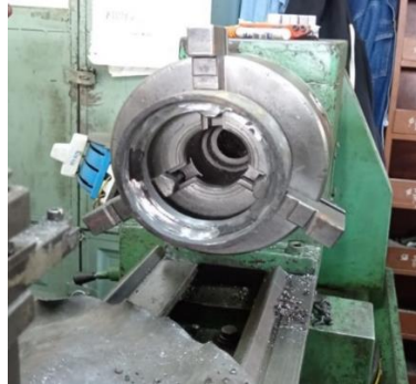
Figura 42. Torneado del cuerpo y la tapa de la ventana
