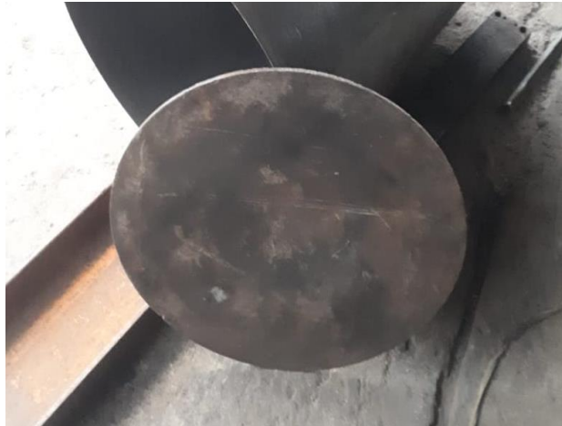
Figura 26. Pieza cortada para el cabezal
