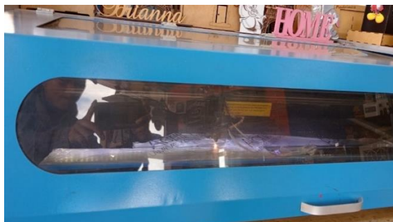
Figura 54. Corte del acrílico a láser
