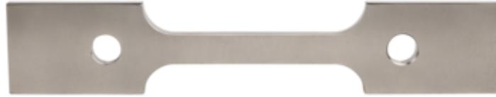
**Figura 2.** Probeta plana para ensayos a tracción DIN EN ISO 6892-2 [27]
