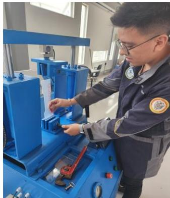
8. Se procede a accionar el sistema hidráulico para realizar el ensayo de tensión.
