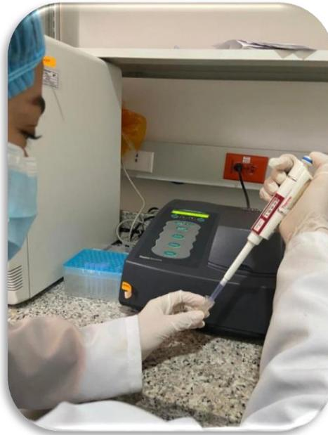
Ubicación de cubetas en espectrofotómetro para medición
