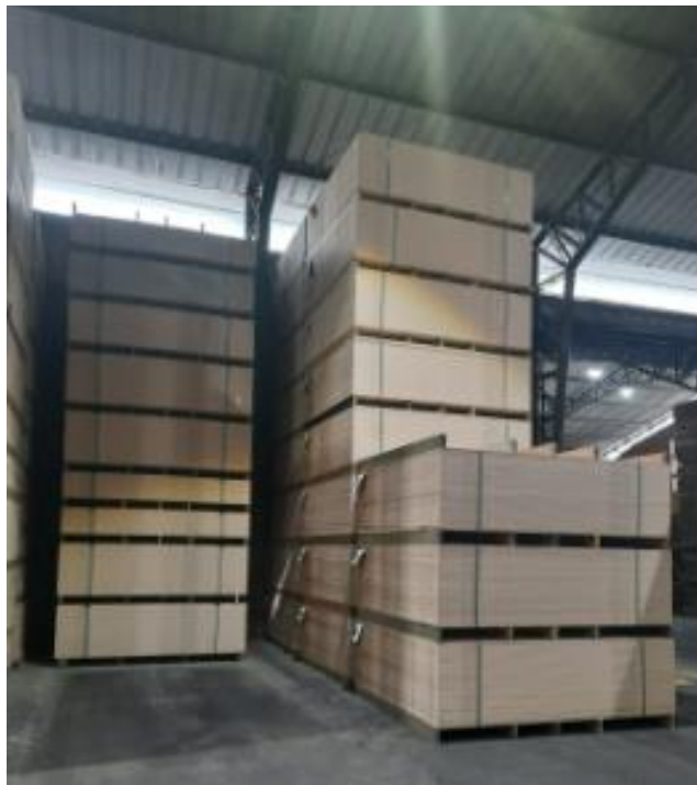
Figura 21: Almacenamiento y enfriamiento de tableros recubiertos
