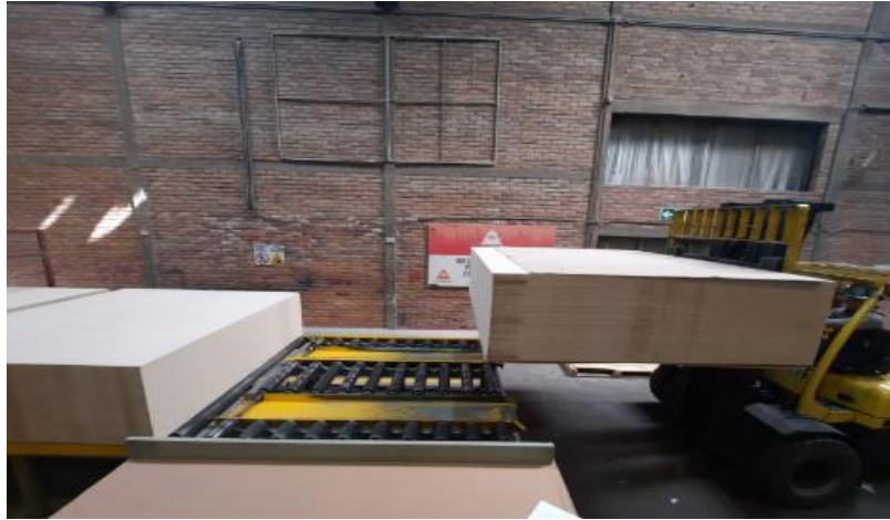
Figura 13: Ingreso de tableros a la prensa Wemhoner
