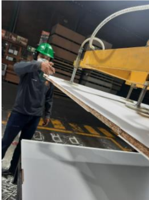
Figura 18: Medición de espesores de tableros recubiertos.
