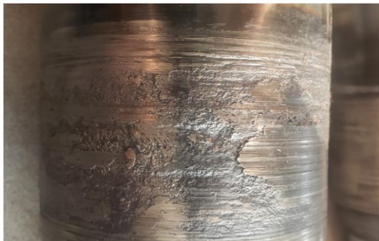
Figura 9 Averías en el eje motriz
