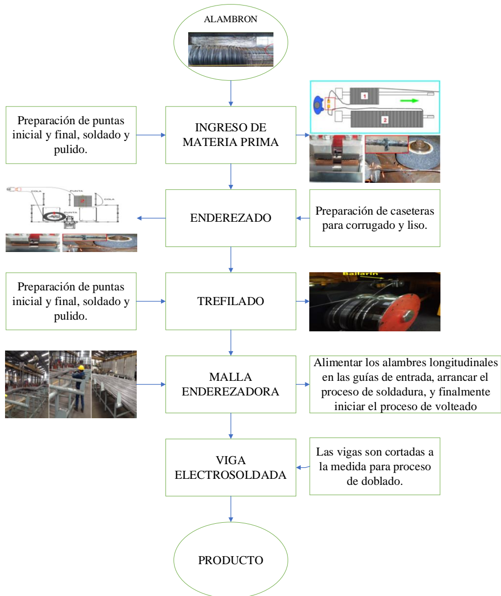
Figura 2 Proceso de elaboración de mallas.
