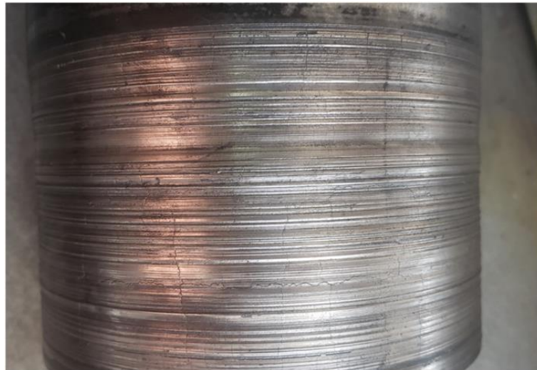
Figura 10 Rayadura de ejes.
