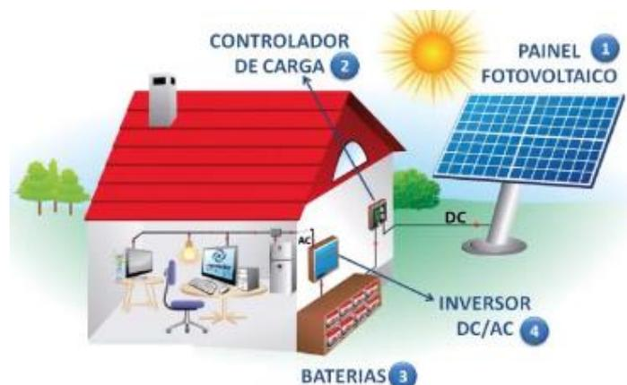
Figura 7. Sistema autónomo OFF GRID
