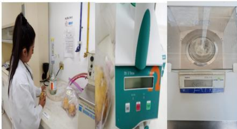
Figura 9. Determinación acidez titulable en zumo de pitahaya amarilla
