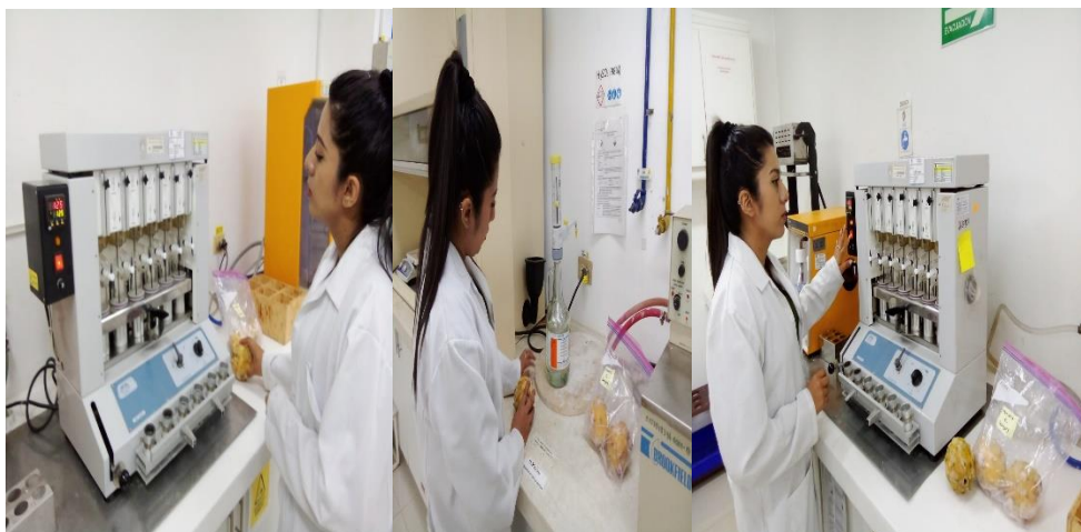
Figura 8. Determinación de grasa total de la pulpa de pitahaya amarilla
