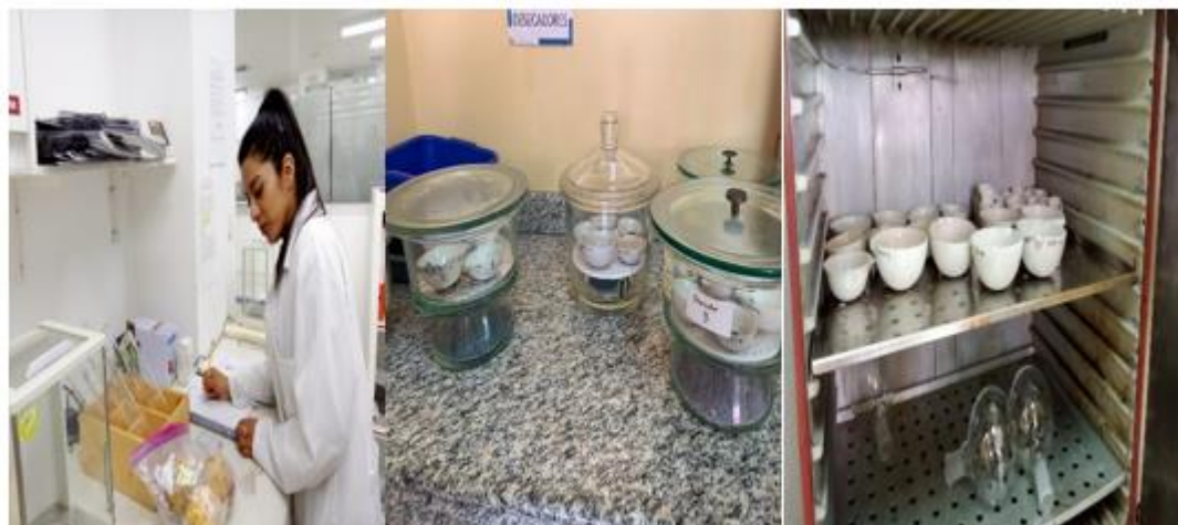
Figura 5. Determinación del porcentaje de Humedad de la pitahaya amarilla
