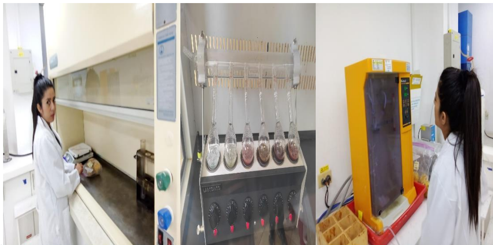
Figura 7. Determinación de proteína de la pulpa de pitahaya amarilla
