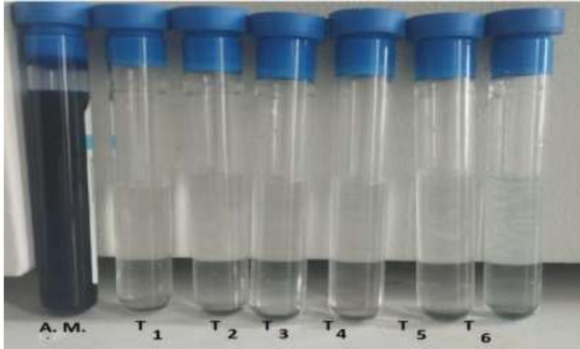
**Figura 4. 4:** Muestras que ilustran el proceso de eliminación del azul de metileno expuesto a la totora modificada en (0, 15, 30, 45, 60, 75, 90) min.
