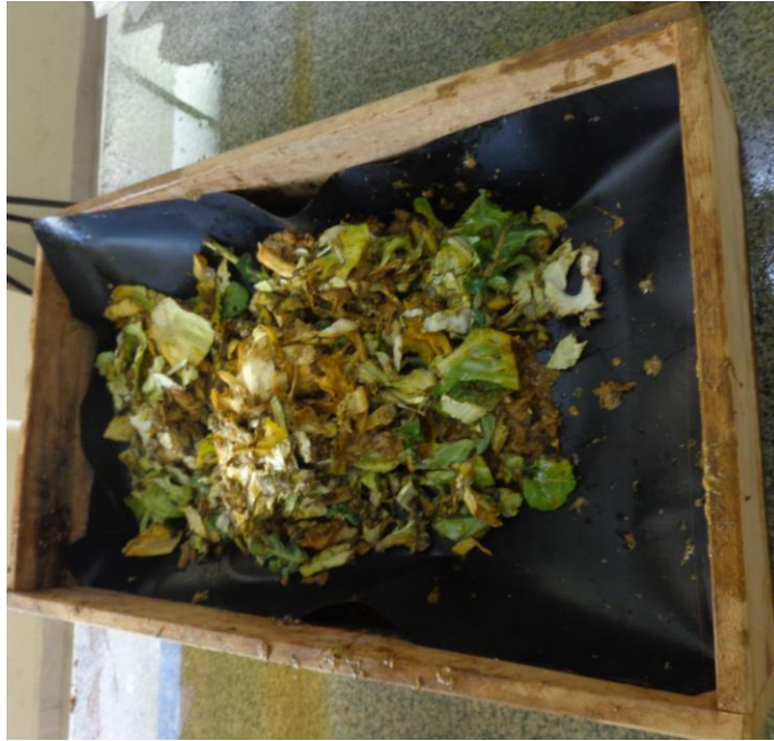
Figura 16. Colocación de geomembranada tipo sánduche.
