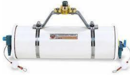
Figura 5. Botella Van Dorn muestreo aguas superficiales
