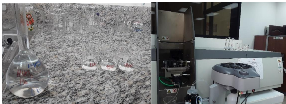
Figura 12. Medición de metales pesados Mediante el Espectrofotómetro de Absorción Atómica PG INSTRUMENTS AA500 con horno de grafito.
