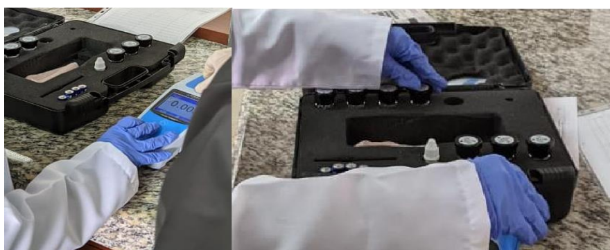
Figura 13. Medición de la turbidez utilizando el turbidímetro portátil TN400 TURBIDITY
