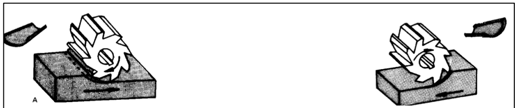
Figura 19. Proceso de Fresado. a) en paralelo, b) en oposición [10].
