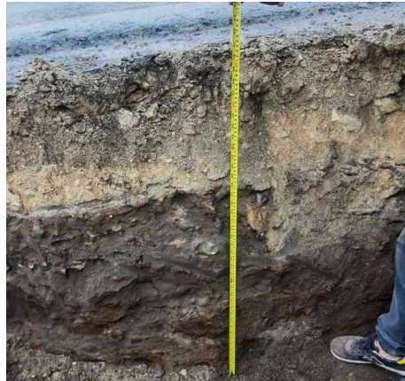
Medición de pozo a cielo abierto y elección de muestras
