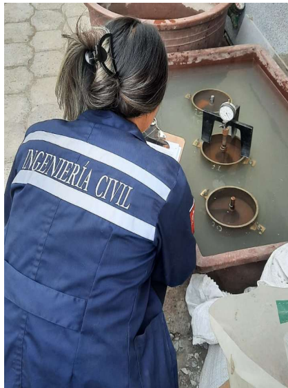
Saturación de moldes de CBR
