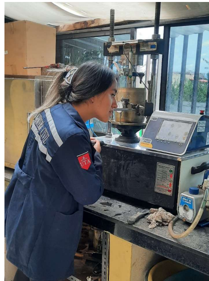
Ensayo de CBR
