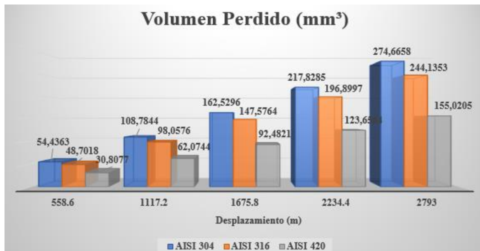
Figura 14: Representación gráfica del volumen perdido con el disco Shore A70 \pm 2,0.
