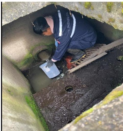
*Figura 19. Medición de caudales de entrada.*
