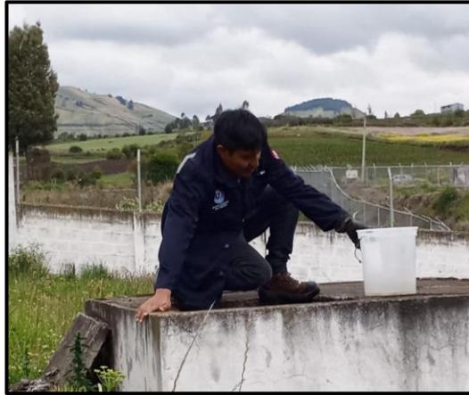
**Figura 21.** *Recolección de muestras de entrada de agua residual PTAR*
