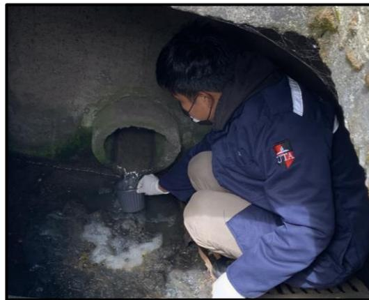
**Figura 22.** *Recolección de muestras de salida de agua residual PTAR.*
