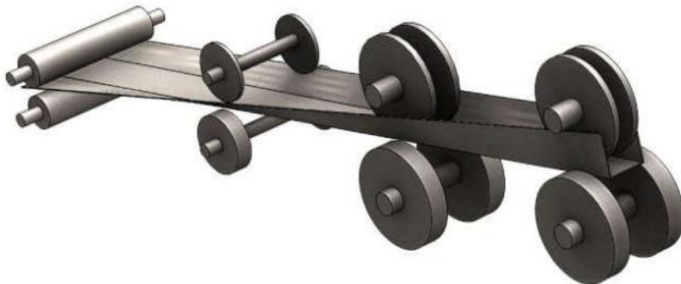
Figura 1.5 Formado de perfiles con rodillos de contorno [32]
