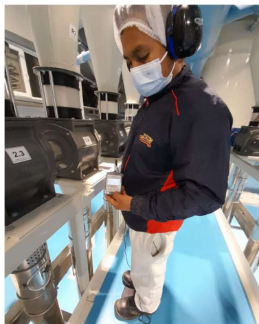
Fotografía 3. Medición de la VTCE en los 3 ejes ortogonales. (Moliner)
