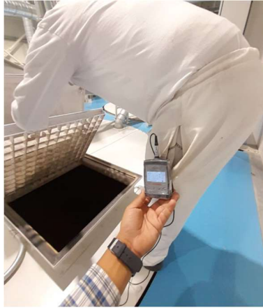
Fotografía 10. Medición de la VTCE en los 3 ejes ortogonales. (Ayudante)
