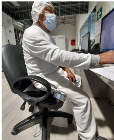
Fotografía 8. Medición de la VTCE en los 3 ejes ortogonales. (Ayudante)
