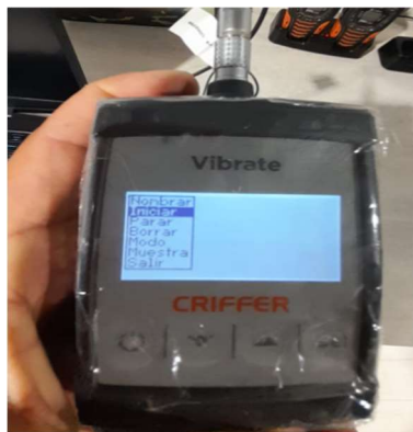
Figura 12 Indicaciones para ingresar al menú del equipo de medición con el sensor.
