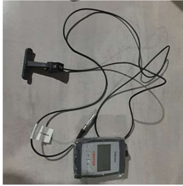
Figura 19 Anclaje del sensor de vibración para sistema mano brazo.
