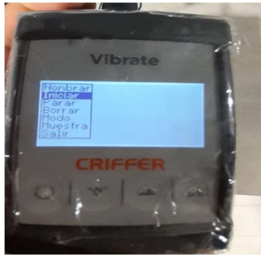
Figura 17 Inicio de la medición con el registro de datos.
