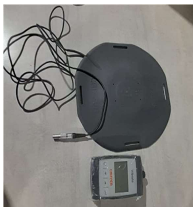
Figura 10 Anclaje de sensor de vibración para cuerpo entero.
