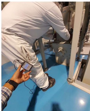
Fotografía 9. Medición de la VTCE en los 3 ejes ortogonales. (Ayudante)
