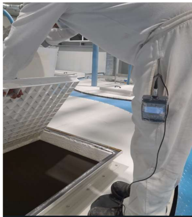
Fotografía 11. Medición de la VTCE en los 3 ejes ortogonales. (Ayudante)
