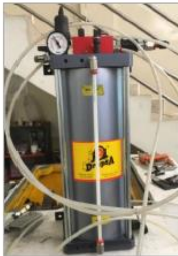
Figura 7. Sistema de mínima cantidad de lubricante.
