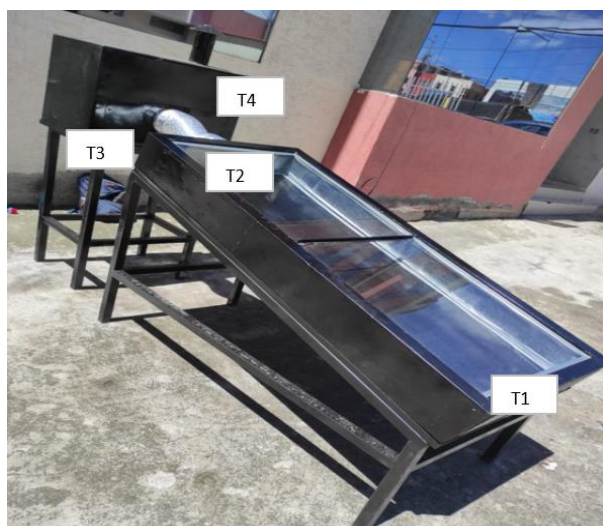
Figura 29.- Esquema de temperaturas en el sistema
