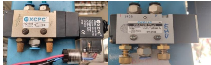
Figura 15: Electroválvulas de control de los actuadores neumáticos.
