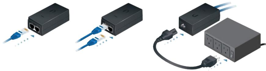
Figura G3. Pasos de la conexión del adaptador Poe[50].
