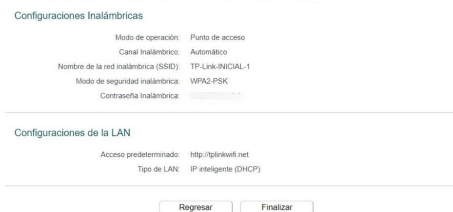
Figura 139 Detalle de la configuración del segundo router para el sector de inicial
