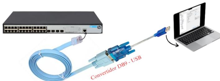
Figura E11. Método de conexión con convertidor DB9 – USB
