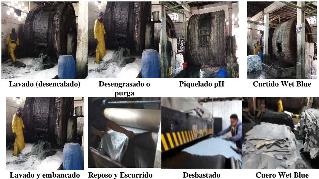
Nota: La tabla muestra imágenes del proceso de curtido paso a paso, fuente: Curtiembre Quisapincha (2023), elaborado por: López (2023)
