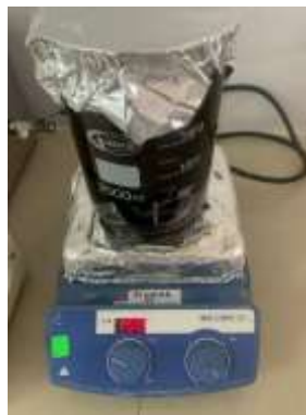
Figura 10 Despulpado con NaOH al 10%
