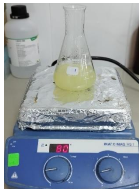
Anexo C. 2. Extracción de inulina por 60 min a 500 rpm
