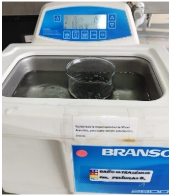
Anexo D. 1. Pre calentamiento del Buffer a 60 °C por 10 min
