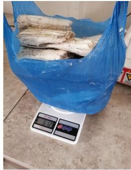
2. Secado del bagazo a 50 °C por 12 horas.
