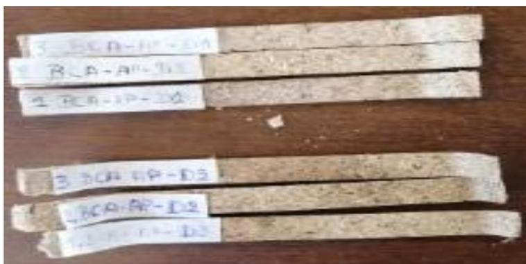
**Figura 43.** Probetas para el ensayo de flexión.
