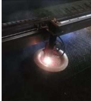
**Figura 40.** Corte de probetas con láser.
