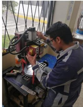
6. Montaje del molde en la máquina de elaboración de platos con material biodegradable.
