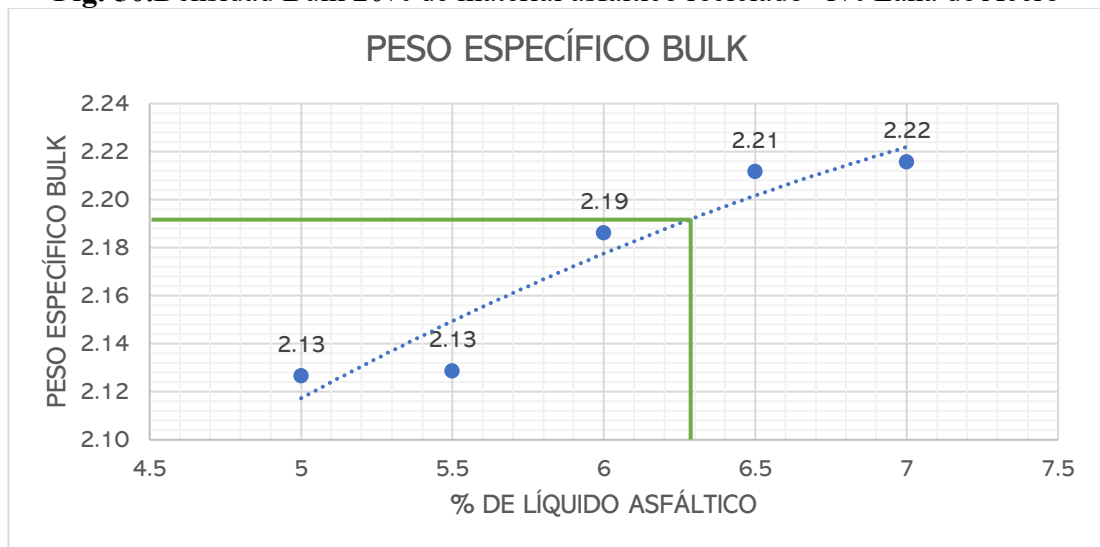
Fig. 50. Densidad Bulk 20% de material asfáltico reciclado -1% Lana de Acero
