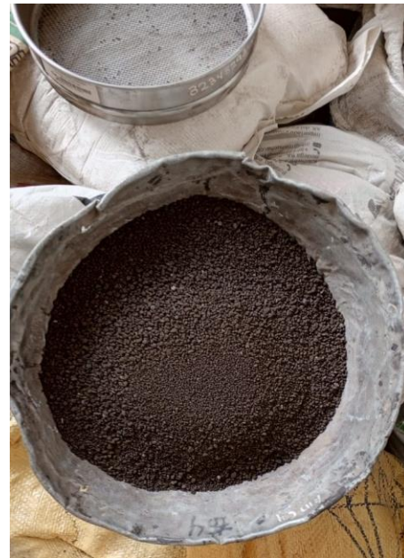
Pesado del material Tamizado por la malla N°12
