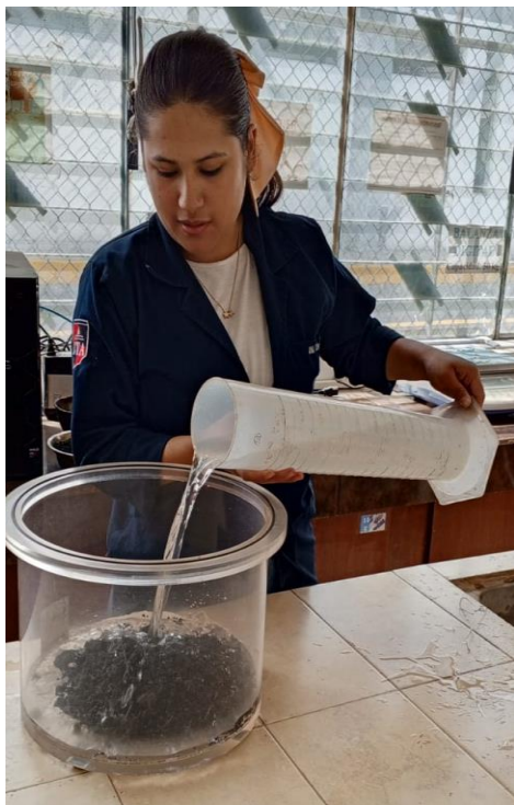
Llenado de agua hasta cubrir la muestra
