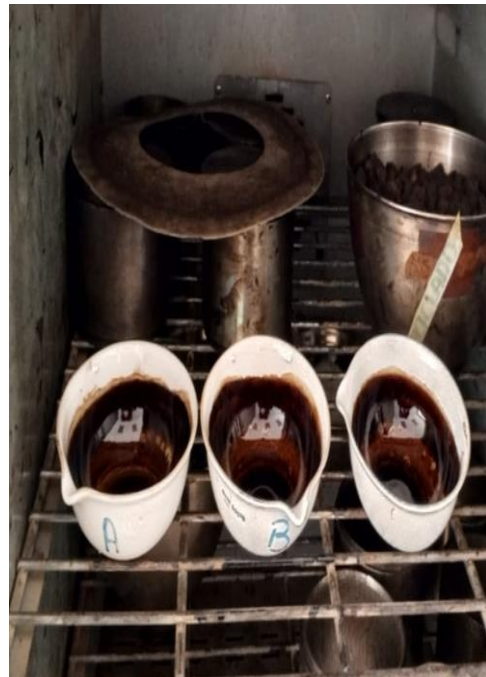
Evaporación de alícuota 160 °C
