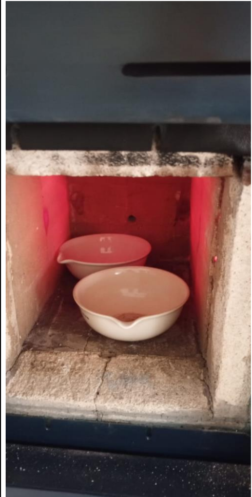
Secado de alícuota en la mufla 550 °C
