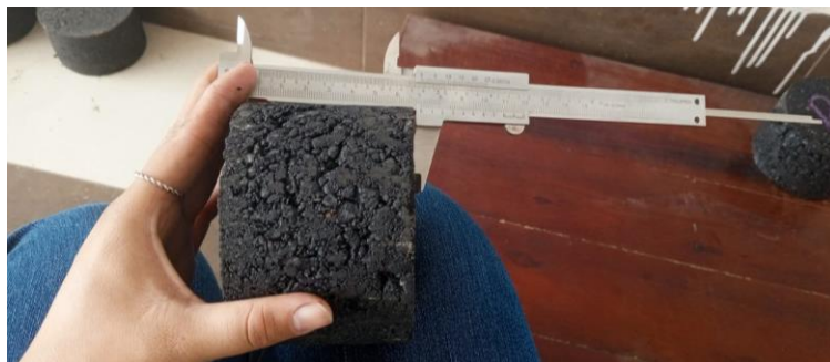
Fig. 11 Determinación de la altura de cada briqueta
