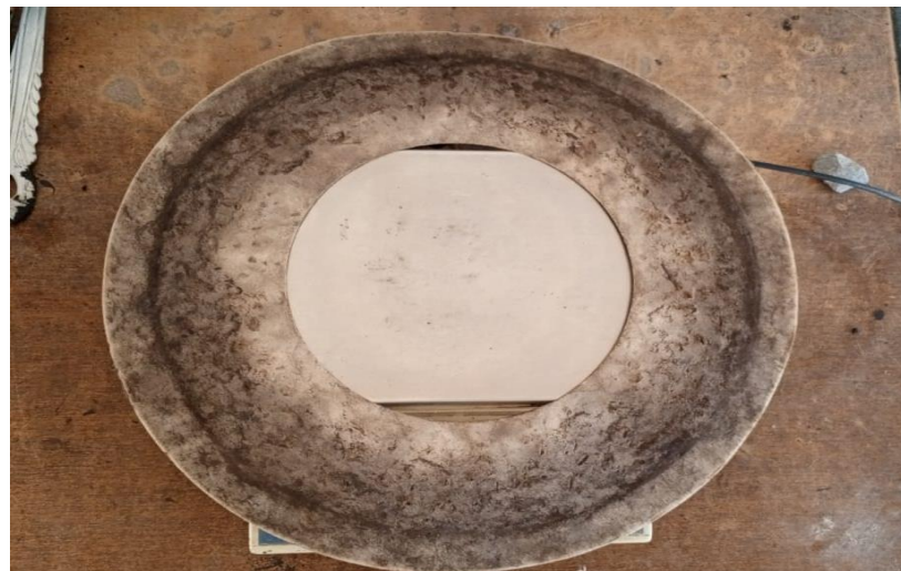
Peso de filtro después de 8 ciclos de lavado asfáltico
