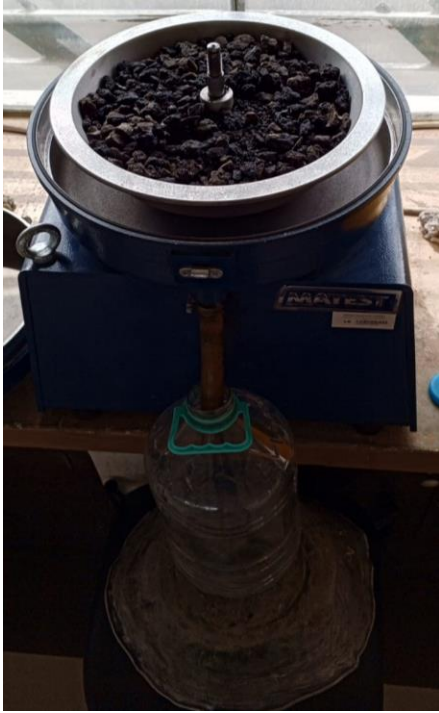
Lavado asfáltico con gasolina
