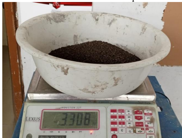
Pesado del material Tamizado por la malla N°12
