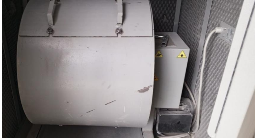
Inicio del ensayo en la máquina de Abrasión de los Ángeles
