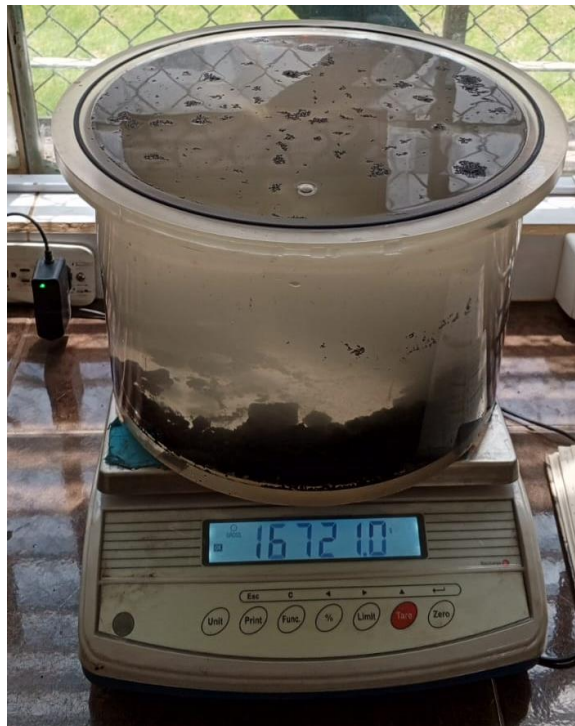
Llenado del recipiente con agua hasta el raz y pesado de la misma
