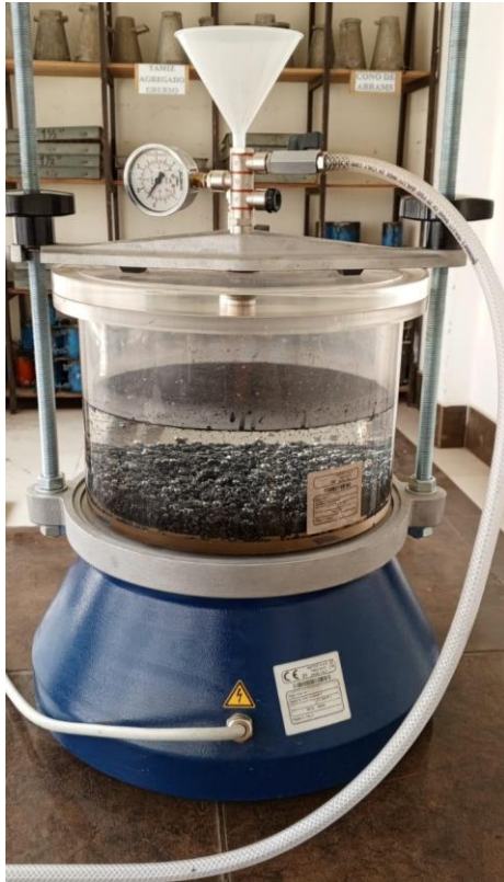
Llenado del recipiente con agua hasta el raz y pesado de la misma
