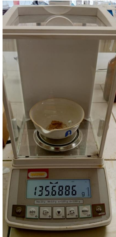
Peso de residuo después del secado en la mufla
