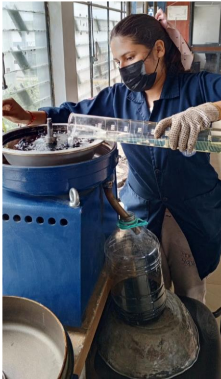
Lavado asfáltico con gasolina
