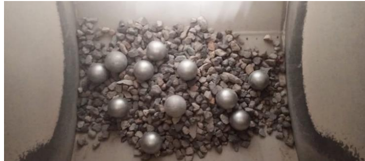
Fig. 5 Ensayo de Abrasión - Método B
