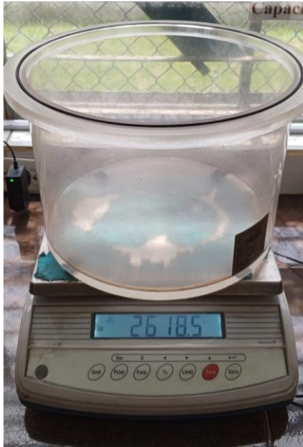
Llenado de agua hasta cubrir la muestra
