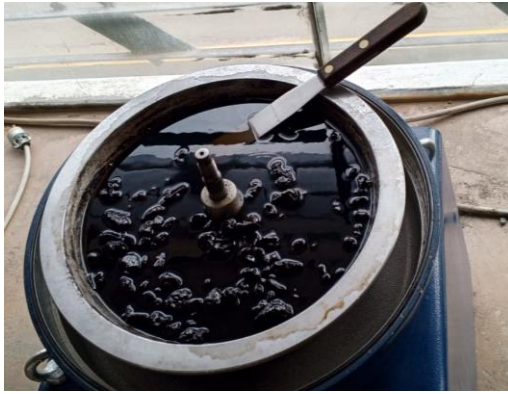
Fig. 16 Inicio del lavado asfáltico
