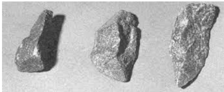
Fig. 9 Agregado con una o varias caras fracturadas
