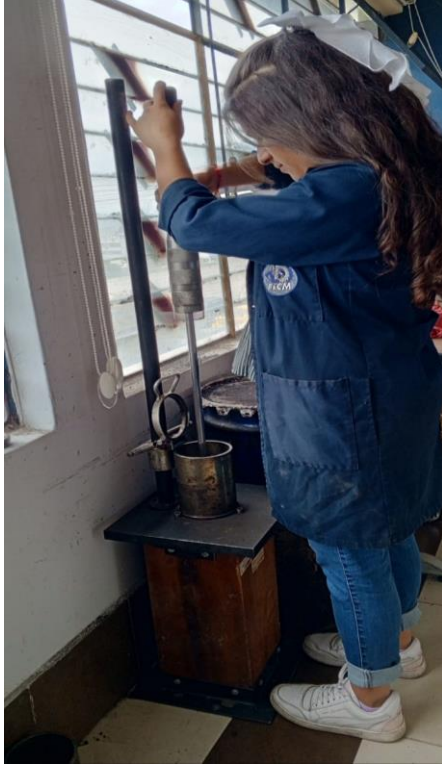
Compactación de mezclas asfálticas
