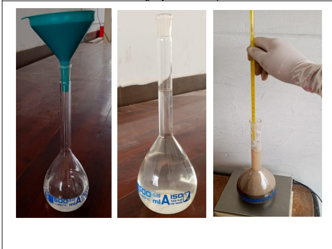
Picnómetro + agua y toma de temperatura
