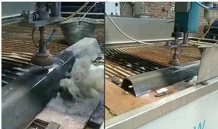
Figura 15. Mecanizado por Abrasive Water Jet Cutting de las probetas de 10 y 12 mm de espesor.
