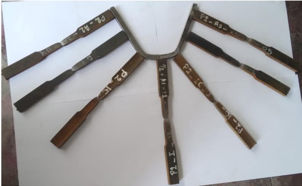
Anexo 6. Clasificación de probetas por secciones y espesores.
