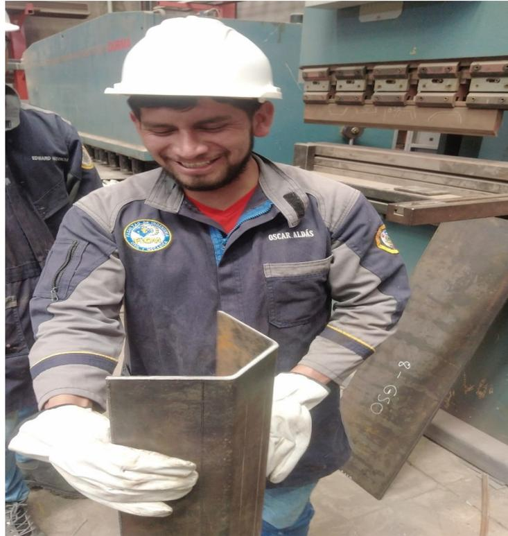
Anexo 4. Extracción de probetas normalizadas del perfil UV conformado en frío.
