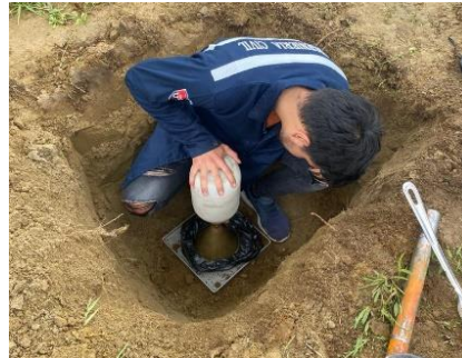
Ilustración 2: Ensayo Densidad de Campo (Cono y Arena de Ottawa)
