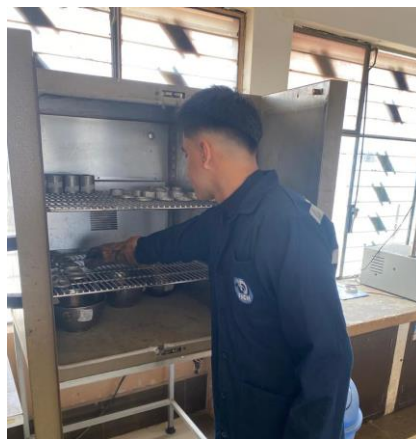
Ilustración 4: Ensayo de Contenido de Humedad
