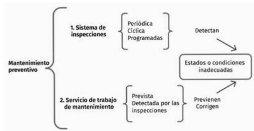
Figura 1. Implementación del mantenimiento preventivo [6].
