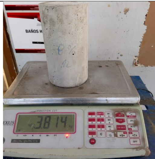
Fotografía 30.- Toma de peso de probetas
