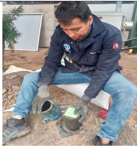
Fotografía 28.- Desmolde de los cilindros
