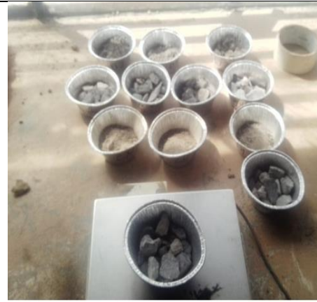
Fotografía 22.- Toma de muestras para contenido de humedad
