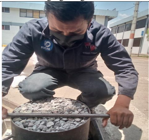
Fotografía 9.- Densidad aparente del agregado grueso
