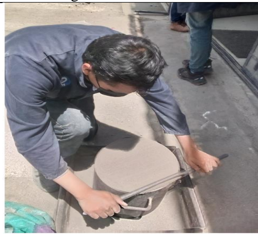
Fotografía 10.- Densidad aparente del agregado fino
