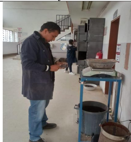
Fotografía 6.- Toma de peso de agregado grueso
