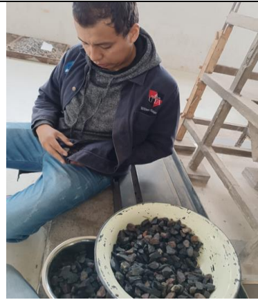
Fotografía 16.- Secado de muestra para obtención de grava SSS
