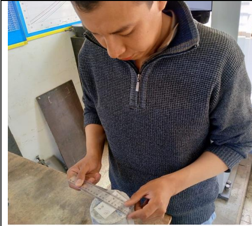
Fotografía 31.- Toma de dimensiones de probetas
