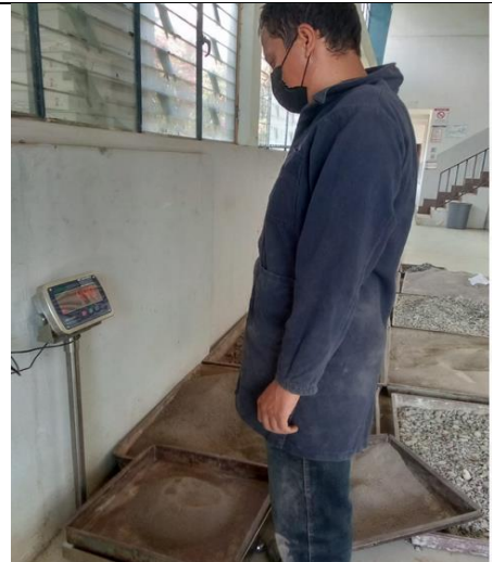
Fotografía 24.- Peso de arena para dosificación
