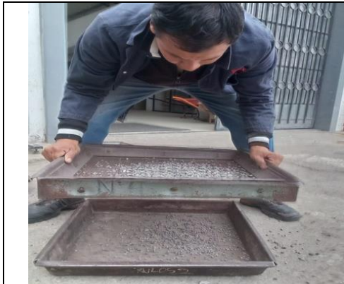
Fotografía 7.- Tamizado del agregado grueso
