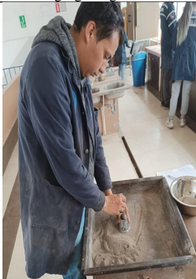
Fotografía 11.- Comprobación si la muestra de arena se encuentra en estado SSS
