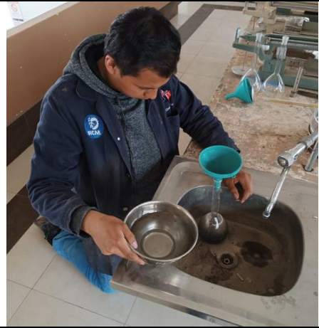
Fotografía 14.- Colocación de agua en pycnómetro con muestra de arena SSS
