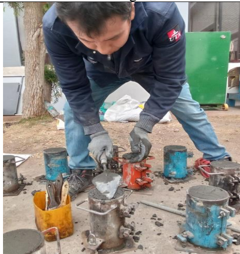
Fotografía 27.- Colocación de la mezcla en los cilindros metálicos
