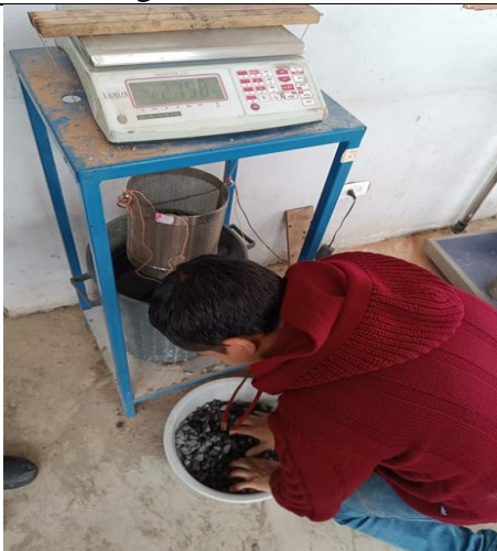
Fotografía 17.- Uso de canastilla para ensayo de densidad real de la grava
