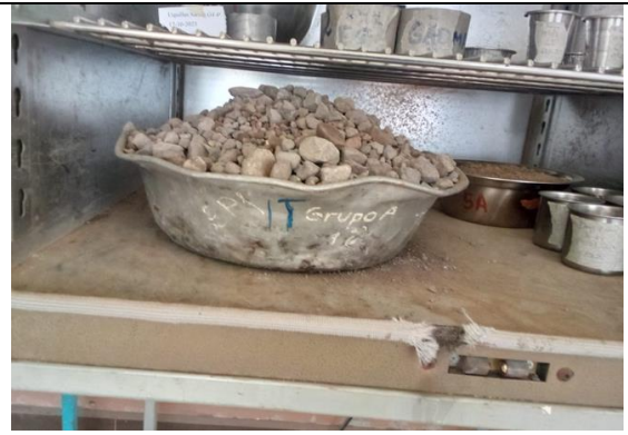
Fotografía 8.- Muestra de agregado grueso en el horno
