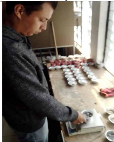
Fotografía 18.- Toma de pesos para capacidad de absorción.
