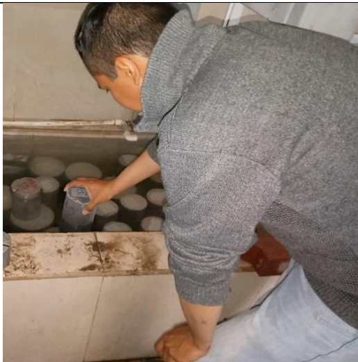
Fotografía 29.- Colocación de probetas en la cámara de curado
