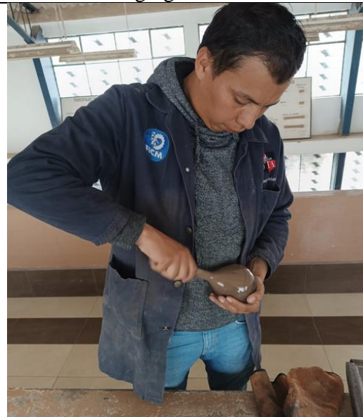
Fotografía 12.- Sacando las burbujas de aire para la eliminación de vacíos para la densidad real de la arena
