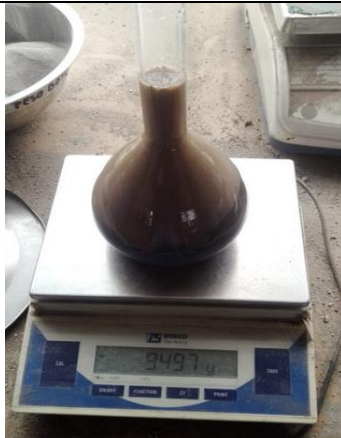
Fotografía 15.- Peso de pycnómetro+ agua+muestra SSS
