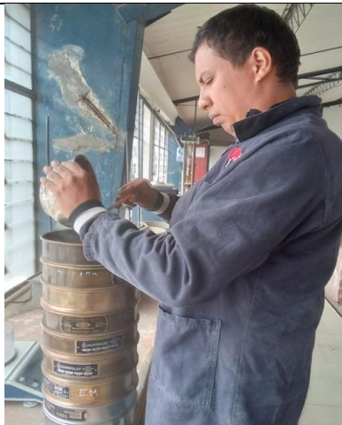
Fotografía 5.- Ensayo de granulometría de agregado fino.
