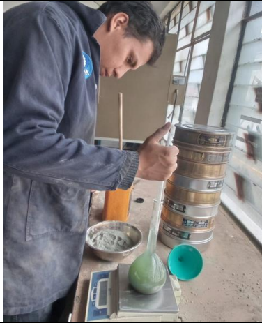
Fotografía 19.- Densidad real del cemento
