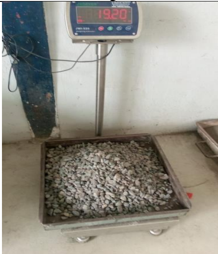
Fotografía 23.- Peso grava para dosificación
