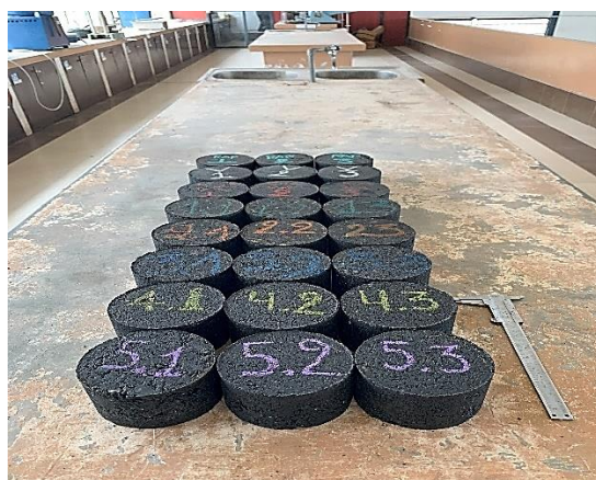
Briquetas con diferentes porcentajes de vidrio, pavimento asfáltico reciclado y AC-20
