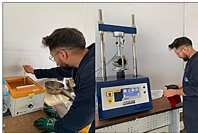
Ilustración N° 17.- Ensayo de briquetas en máquina Marshall
