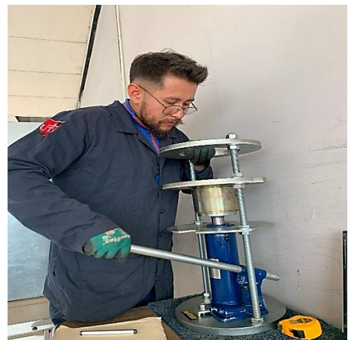
Extracción de la briqueta mediante el uso de la prensa
