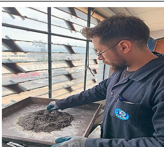
Secado del agregado mediante una corriente ligera de aire caliente
