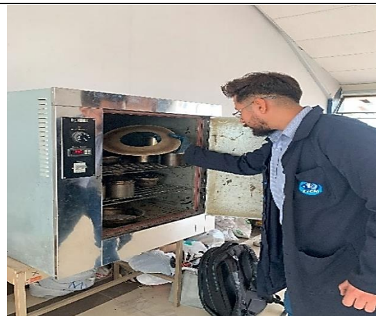
Deseccación del fitro con miras a su pesaje ulterior
