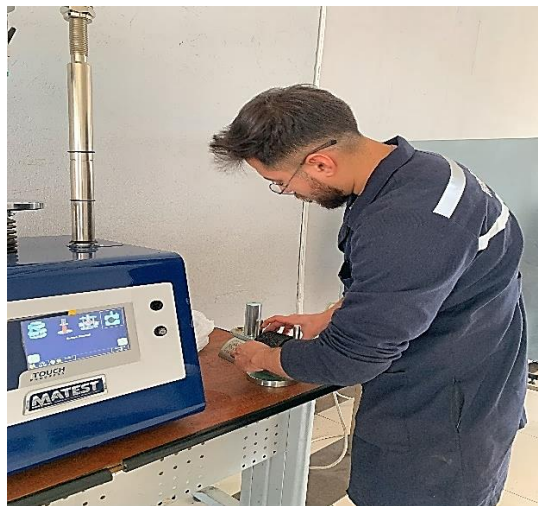
Colocación de briquetas en las mordazas del equipo Marshall
