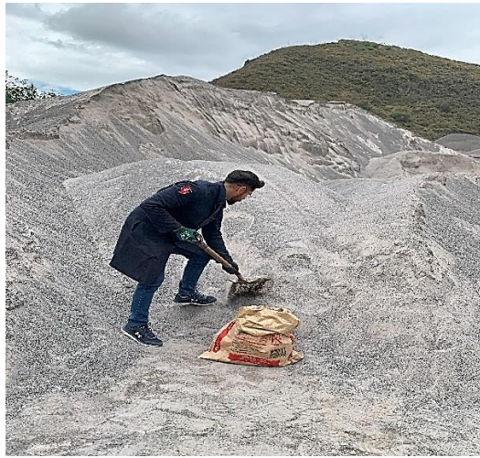
Recolección de agregados pasantes del tamiz N°4
