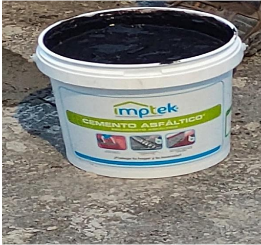
Cemento asfáltico utilizado para impermeabilizar las superficies hormigonadas
