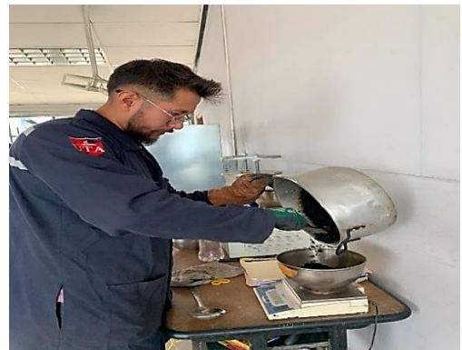
Colocación y pesaje de la mezcla asfáltica para llevarla al horno durante 1 hora como mínimo
