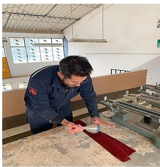
Eliminación de aire presente en la probeta con agua y muestra
