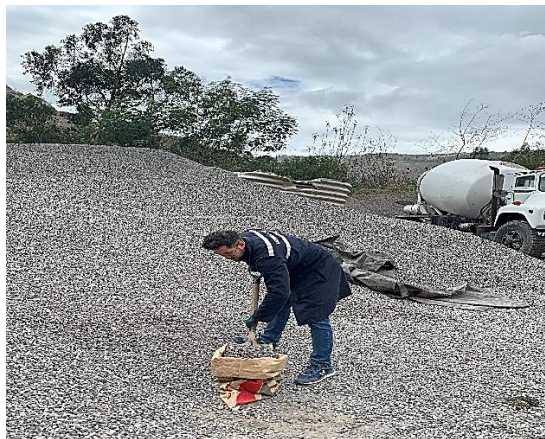
Recolección de agregados pasantes del tamiz N° 3/4"
