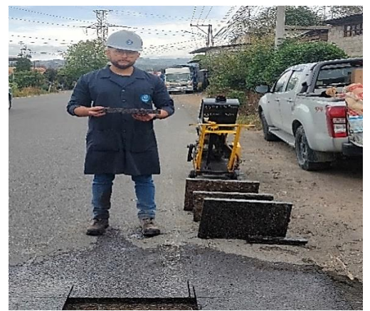
Extracción de la segunda muestra de RAP
