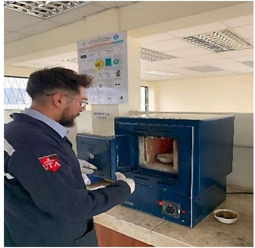
Colocación de la alicuota después de haber sido secada en el horno de 110°C
