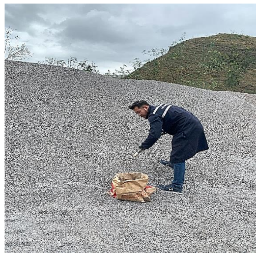
Recolección de agregados pasantes del tamiz N° 3/8"
