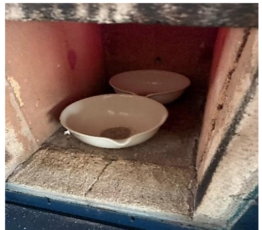
Alicuota después de accionar la mufla a 550°C
