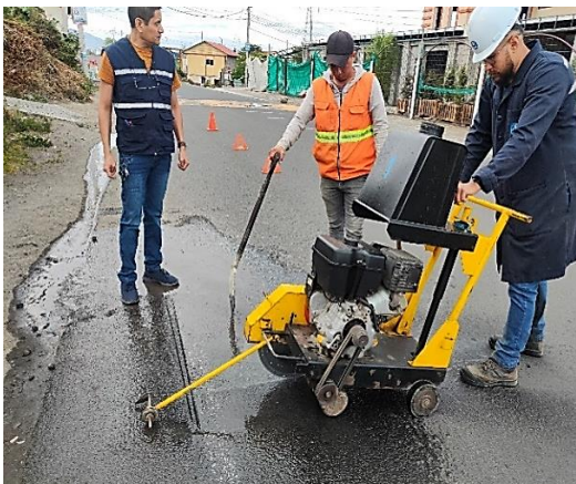
Corte de la segunda muestra de RAP
