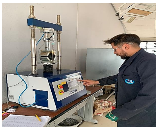
Accionamiento de cargas en el equipo Marshall
