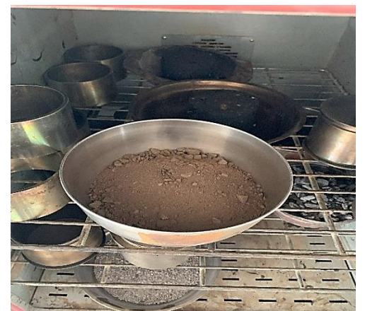
Deseccación de la muestra producto del centrifugado con miras a su pesaje ulterior
