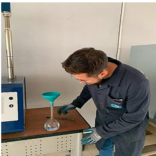
Preparación del picnómetro con la muestra de 500g
