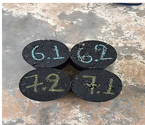
Briquetas con diferentes porcentajes de vidrio, pavimento asfáltico reciclado y AC-20
