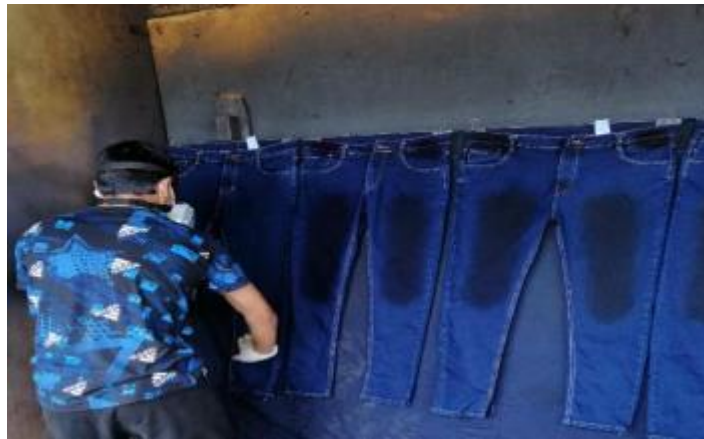
Figura 10. Proceso de sandblasting.
