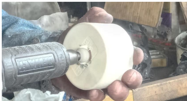
Figura 28: Rectificado de la tapa reductora grande.
