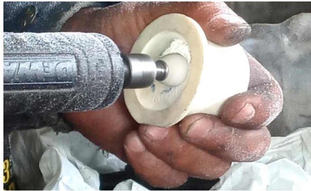
Figura 29: Rectificado de la tapa reductora pequeña.
