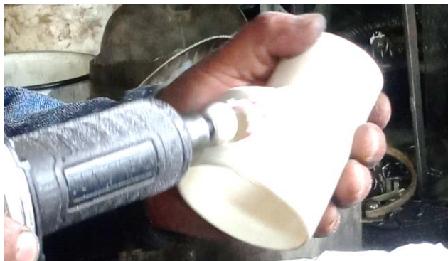
Figura 27. Rectificado del reductor excéntrico.
