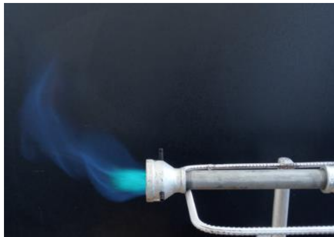
Figura 35: Llama generada por el prototipo final del mezclador de aire-GLP.
