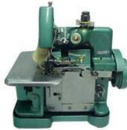
Figura 16: Máquina de coser overlock casera
