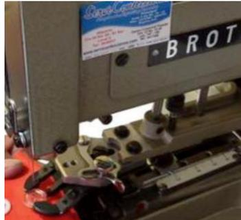
Figura 18: Máquina botonadora.
