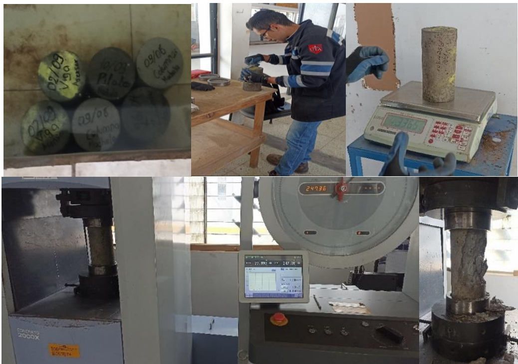
Figura 13. Ensayo de compresión del hormigón
