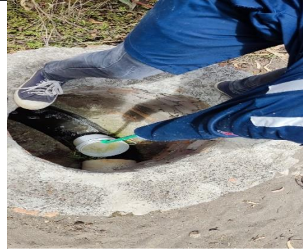
Medición del caudal por el método volumétrico.
