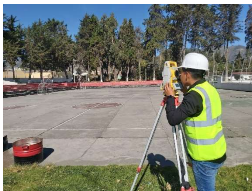
Ilustración 15. Ejecución del levantamiento planimétrico Fuente: fotografía in situ
