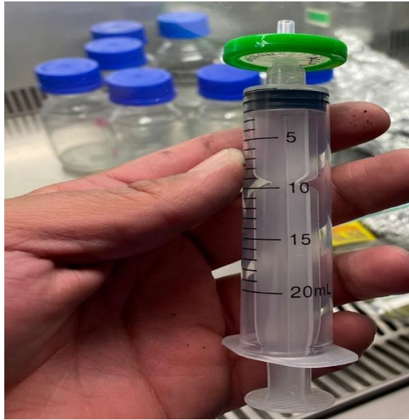
Figura 9. Filtro de jeringa milipore de 0.22 \mu\text{m} para que cada extracto de cada concentración salga esteril de tal manera que no contamine el medio de cultivo donde se va a incorporar P. infestans .
