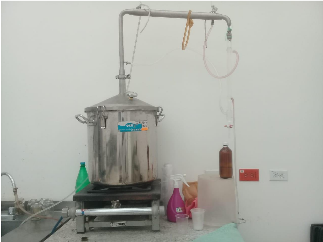
Figura 7. Destiladora de aceites esenciales en funcionamiento.
