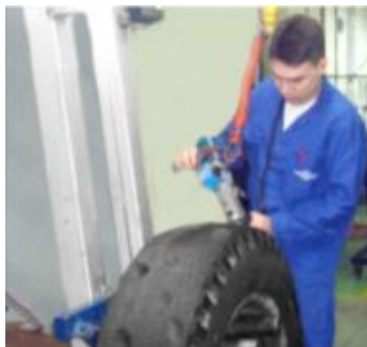
Imagen N° 9. Aplicación de relleno de caucho
