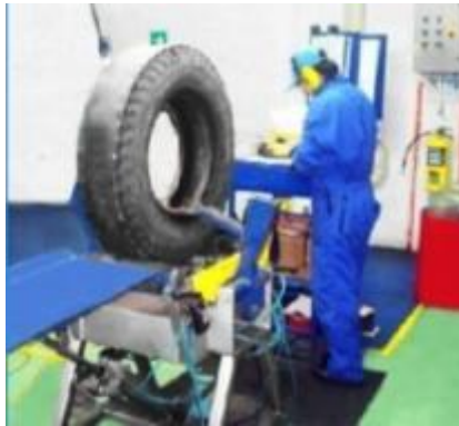
Imagen N° 5. Inspección de neumáticos antes del reencauchado
