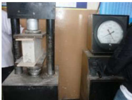
Imagen N° 32 Aplicación de carga al bloque
