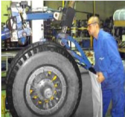
Imagen N° 11. Colocación de la nueva banda en el neumático
