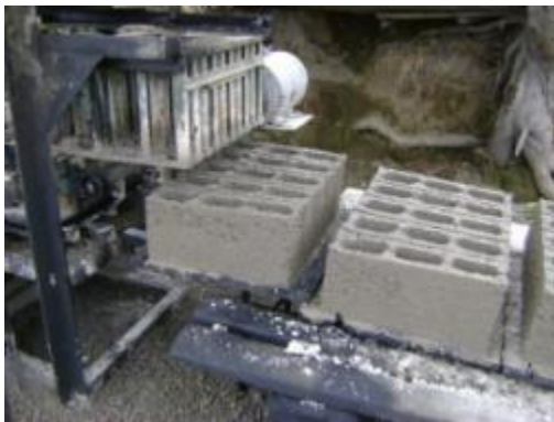
Imagen N° 27 Desmoldado de bloques
