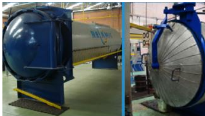
Imagen N° 13. Proceso de Curado o vulcanizado en una autoclave
