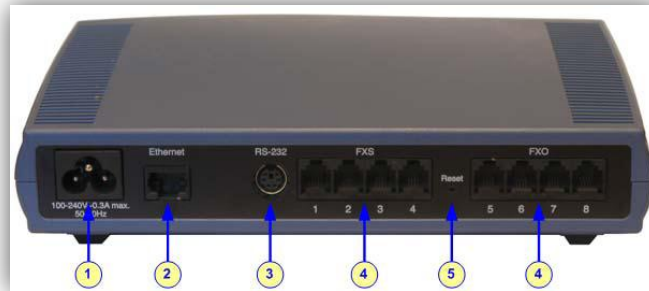
Figura 6.34. Puertos de AudioCódigoc MP118 FXO
