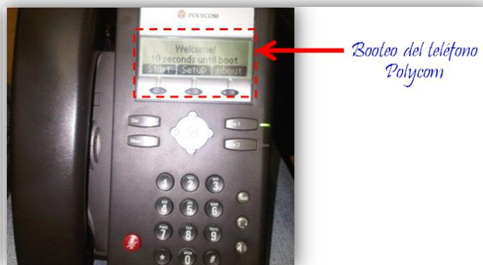
Figura 6.43. Inicialización del teléfono Polycom Soundpoint IP 330
