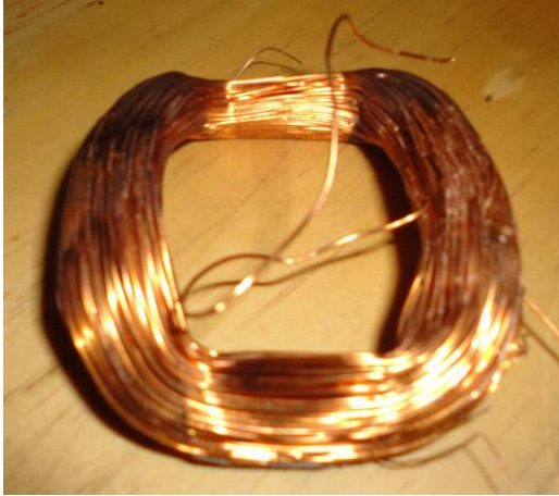
Foto N. 9: Formación de la bobina de cobre (*)
