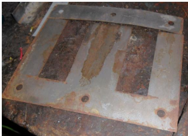
Foto N. 8: Núcleo cerrado en forma de I (*)
