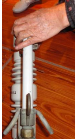
Foto N. 29: Seccionador con portafusible (*)
