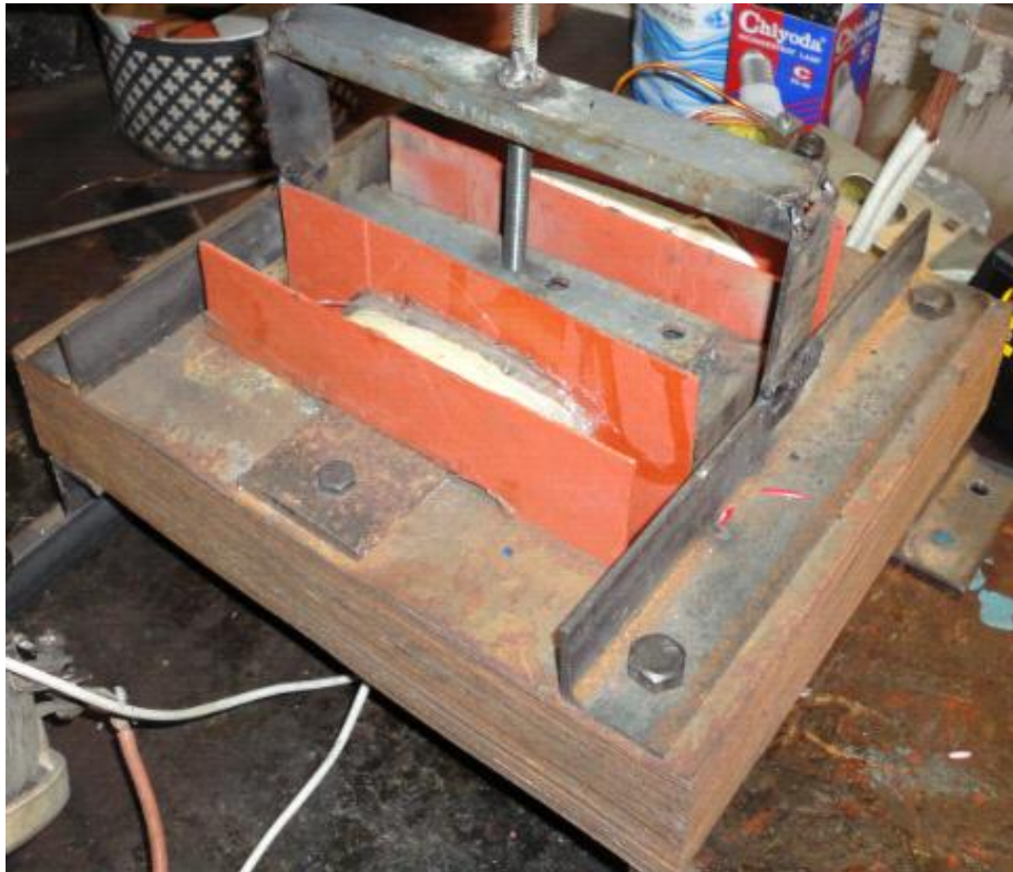
Foto N. 12: Estructuración del núcleo y shut magnético (*)
