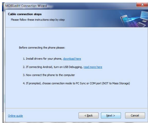
Figura 6. 41 Pasos para la conexión por cable (MOBILedit)
