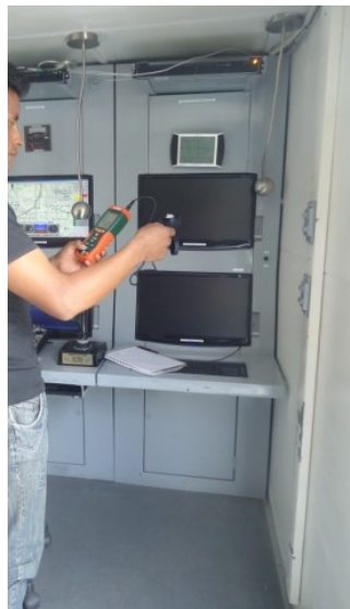
Figura N° 4.11: Medición de la luminosidad.
