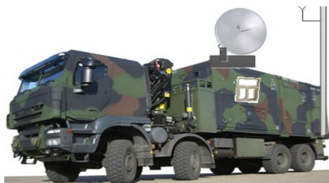
Figura N° 2.8: Shelter sobre vehículo de transporte.
