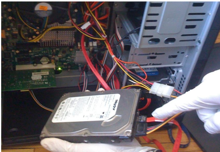
Imagen 126: Extracción del disco comprometido
