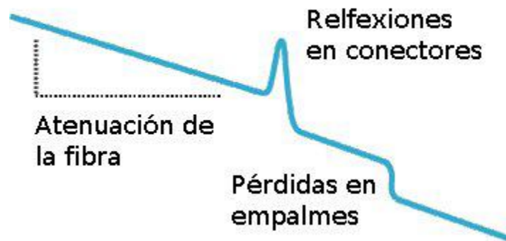
FIGURA 6.24 Descripción de la reflectometría con el OTDR
