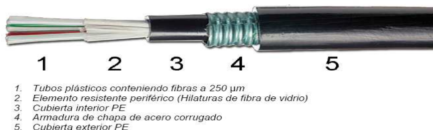
Fig. 2.14. Cable de estructura holgada.
