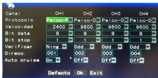
Gráfico 6. 35 Configuración PTZ Fuente: DVR TopBand TBO-9716E
